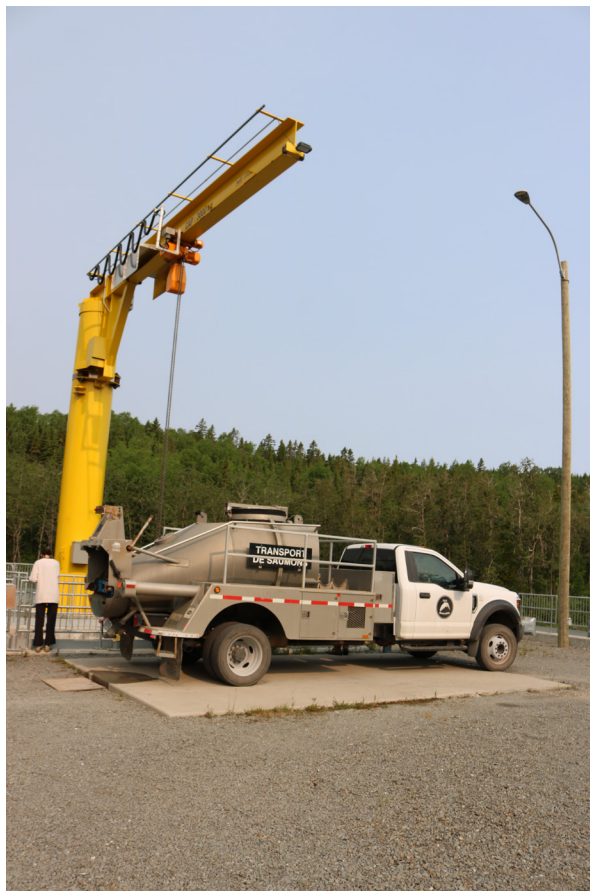
47 La grue place la cage au-dessus du camion de transport où les poissons sont déversés dans la citerne d'acier.
