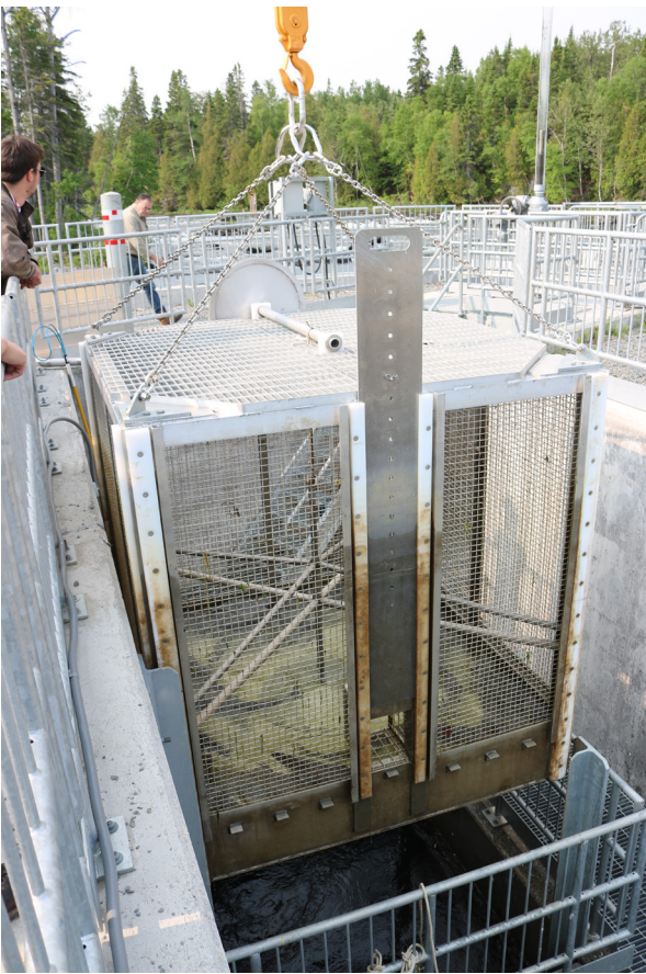
46 Lorsque plus ou moins une douzaine de poissons entre dans la cage, elle est soulevée pour permettre le transfert des saumons dans le camion.
