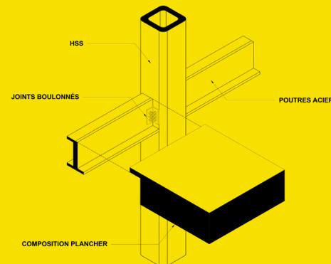
FACILITÉ D'INSERTION PAR UN SYSTÈME MODULAIRE
